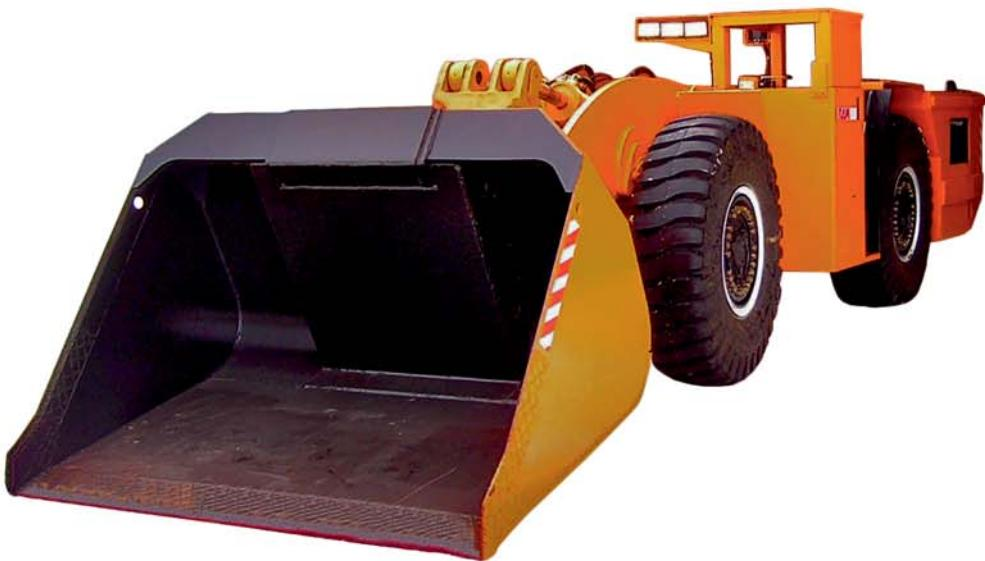
**Назначение:** предназначена для погрузочно-доставочных работ и монтажа оборудования с помощью сменных рабочих органов в подземных горных выработках рудников.
