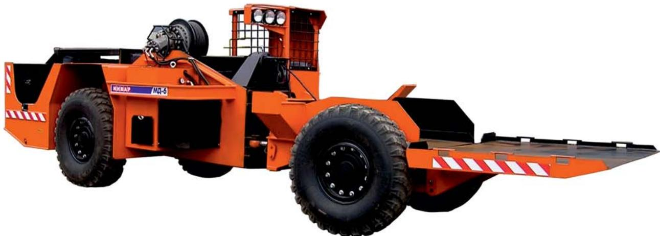
**Назначение:** предназначена для самозагрузки и перевозки грузов в подземных горных выработках рудников.
