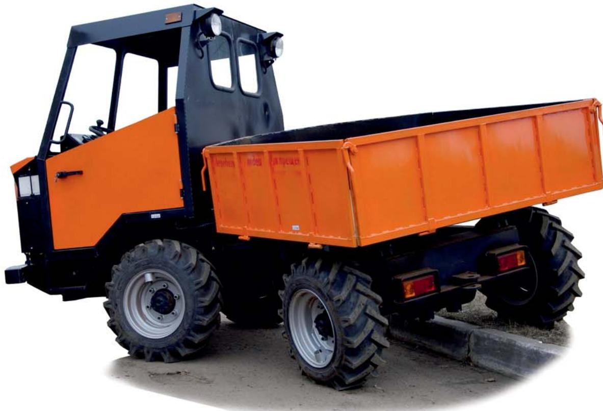
**Специальное трёхшарнирное сочленение рамы машины** обеспечивает не только складывание полурам для осуществления поворота и тем самым повышенную маневренность машины в стеснённых условиях, но и их поперечное качание относительно друг друга, что снижает скручающие нагрузки на раму и повышает тягово-цепные качества ходовых колёс при передвижении по пересечённой поверхности.
