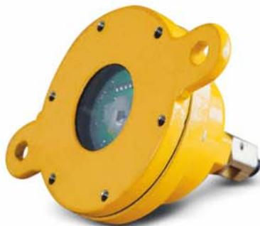
Принцип работы основан на изменении частоты радиосигнала, отраженного от движущегося объекта. Датчик может быть установлен по продольной оси конвейера и параллельно скребкам конвейера в подземных горных выработках, в том числе соляных, опасных по взрыву газа и пыли. Датчик имеет анодированное и полимерное покрытие.
