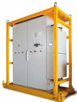
**Станция преобразователя частоты СПЧ** предназначена для изменения частоты и напряжения силовой цепи, управления процессами пуска и остановки, регулирования скорости, защиты от токов перегрузки и короткого замыкания 3-х фазных электродвигателей переменного тока мощностью до 200кВт.
