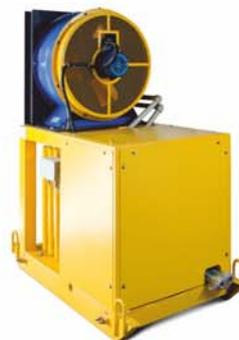
**Установка водяная холодильная УВХ** предназначена для теплообмена между жидким теплоносителем (водоэмульсионная жидкость, вода) в закрытом контуре циркуляции и газообразным теплоносителем (воздухом) в открытом контуре. Используется для охлаждения СПЧ.
